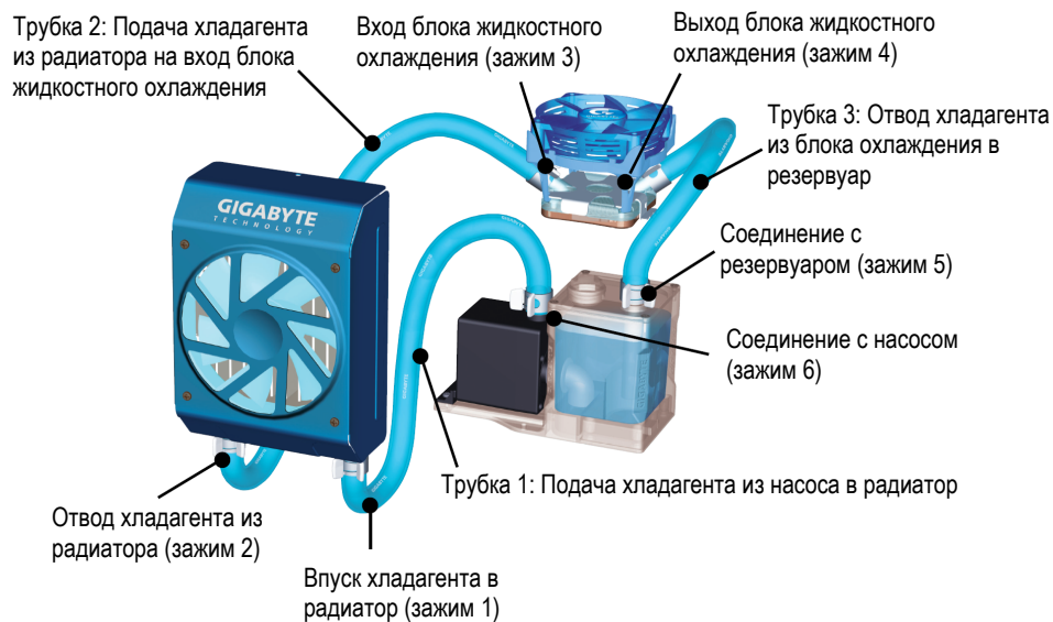
Схема смонтированной системы жидкостного охлаждения
