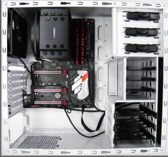
케이스 뒷면에서 원래의 I/O 쉴드를 제거한 후 마더보드 I/O 쉴드로 교체합니다. 마더보드를 I/O 쉴드에 끼워서 제 위치에 놓은 후 케이스 안에 넣습니다. 마더보드의 장착용 나사 구멍을 케이스의 해당 장착용 구멍에 맞춥니다. 나사로 마더보드를 제자리에 고정합니다.
