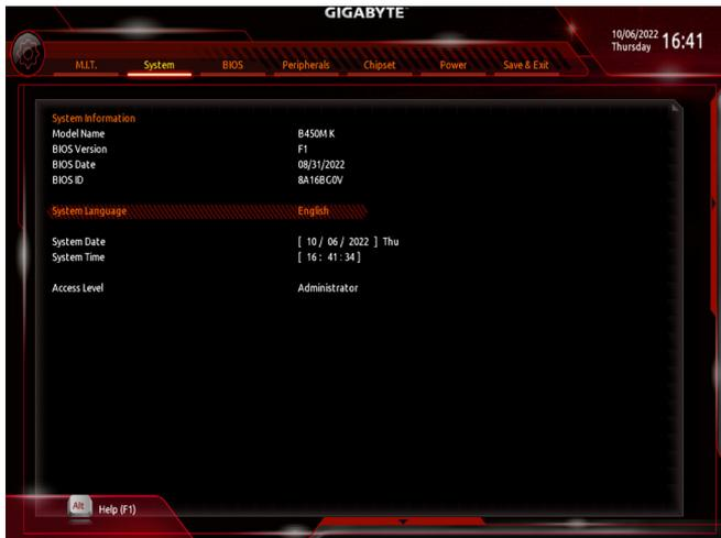
このセクションでは、マザーボード モデルおよび BIOS バージョンの情報を表示します。また、BIOS が使用する既定の言語を選択して手動でシステム時計を設定することもできます。
