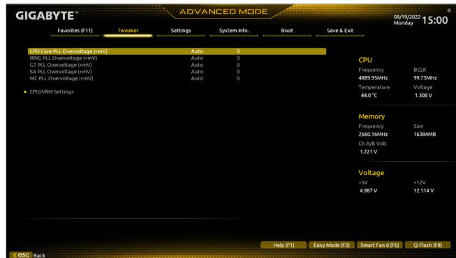
此畫面可讓您調整Load-Line Calibration幅度、過電壓保護值、過電流保護值…等設定。
