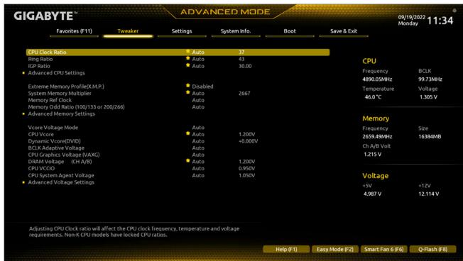
系統是否會依據您所設定的超頻或超電壓值穩定運作，需視整體系統配備而定。不當的超頻或超電壓可能會造成CPU、晶片組及記憶體的損毀或減少其使用壽命。我們不建議您隨意調整此頁的選項，因為可能造成系統不穩或其它不可預期的結果。僅供電腦玩家使用。(若自行設定錯誤，可能會造成系統不開機，您可以清除CMOS設定值資料，讓BIOS設定回復至預設值。)
