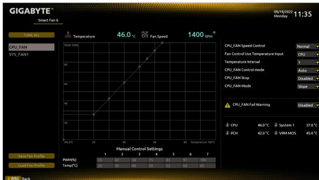
请利用功用键<F6>快速切换至此页面。在此页面您可针对各风扇插座调整转速相关设置，或查看系统/CPU温度。
