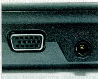
Das Gigabyte P27K bietet neben einem HDMI- auch noch einen analogen D-Sub-Signalausgang (RGB).
