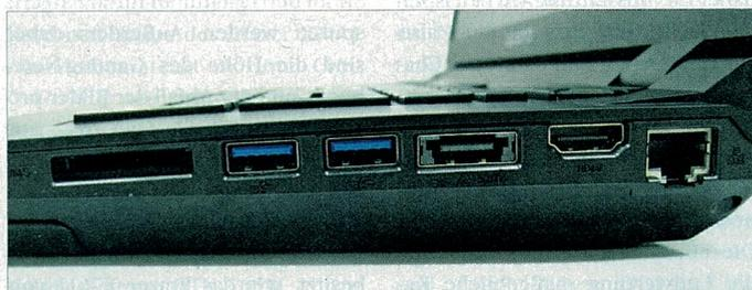
Schnittstellen wie USB 3.0 und E-SATA sorgen für Erweiterungsmöglichkeiten des Massenspeichers, falls die 1-TByte-Festplatte doch voll werden sollte.
