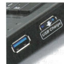
其中1個USB 3.0具備快充功能，提供行動設備1A的電流加快充電速度。
