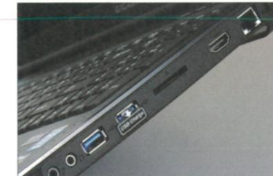
I/O埠右側具備USB 3.0，讀卡機還有HDMI輸出，同時也具備有線網路孔。
