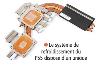
● Le système de refroidissement du P55 dispose d'un unique ventilateur et d'un seul groupe d'ailettes : Gigabyte aurait pu opter pour un système mieux dimensionné pour garantir des nuisances sonores optimales.
