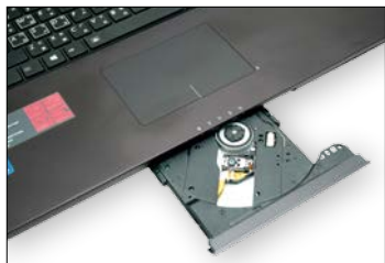
▲光碟機位於觸控板正下方，支援熱插拔，玩家可將其替換成空匣或安裝2.5吋SSD、HDD來增加儲存空間
